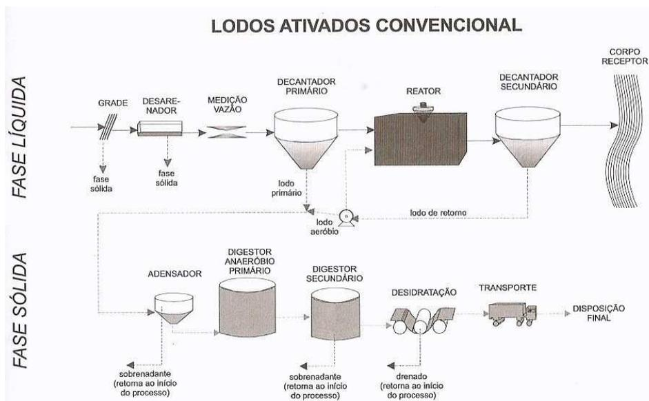
**Figura 7.1.** Fluxograma de um sistema de lodos ativados convencional
