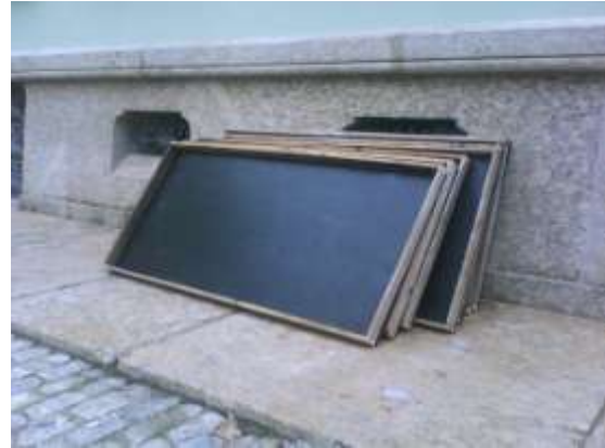
Fig. 12– Placas de madeirit para formas.
