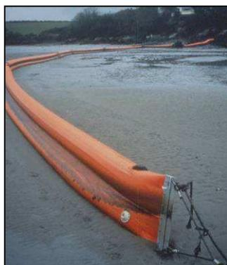
Figura 3-28 – Barreira para selar a costa ou de interface (Fonte: INTERNATIONAL DIRECTORY OF OIL SPILL CLEANUP CONTRACTORS, 2011).
