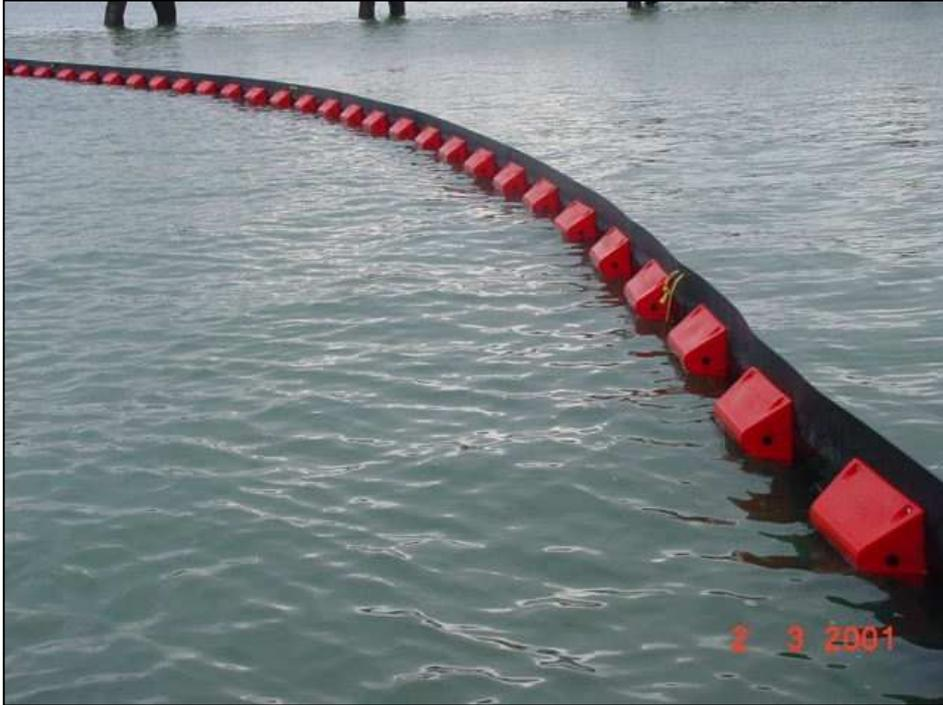
Figura 3-26 – Exemplo de barreira tipo cerca (Fonte: INTERNATIONAL DIRECTORY OF OIL SPILL CLEANUP CONTRACTORS, 2011).
