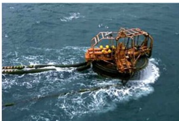
Figura 11. Terminal oceânico não abrigado de Osório, SC, operado por monobóia (Fonte: http://www.petrobras.com.br/pt/quem-somos/principais-operacoes/ ).
