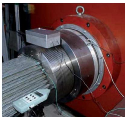
Figura 2.11 – Ensaio para certificação de ancoragem (Tensacciai,2009).
