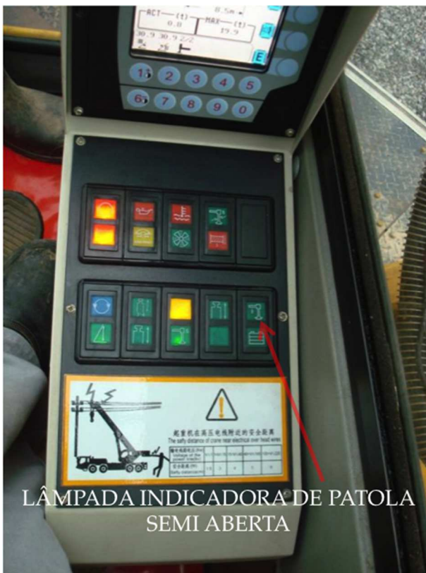
Figura 4.2-6: Painel de controle do guindaste XCMG QY50K e detalhe do interruptor de controle da patola (arquivo pessoal)
