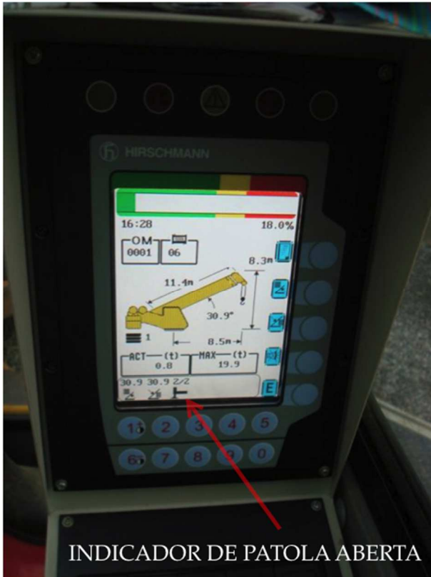
Figura 4.2-5: Interface gráfica do display do LMI - Hirschmann HC 4900 e detalhe da informação sobre a configuração de abertura dos estabilizadores (arquivo pessoal)
