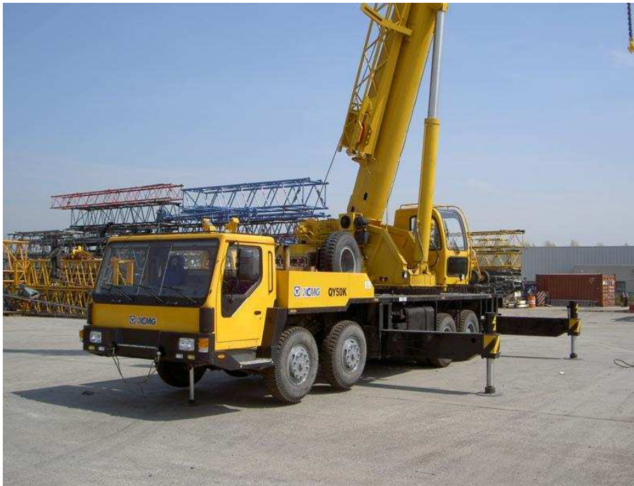
Figura 4.2-1: Guindaste caminhão XCMG QY50K (XCMG, 2012b)
