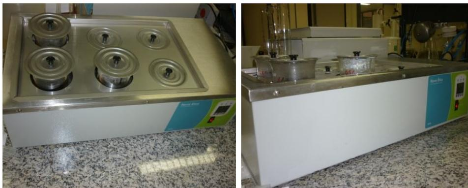
**Figura 19: Regeneração do carvão ativado saturado em béqueres utilizando banho para manter a temperatura de 50°C e 80°C.**
