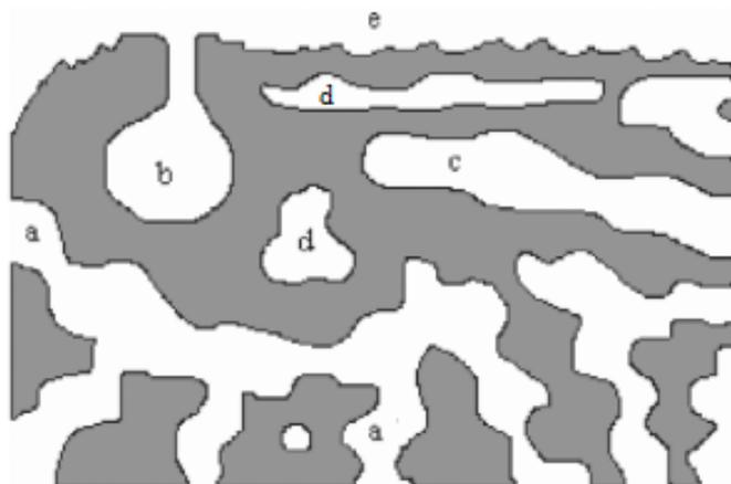
**Figura 4: Representação dos diferentes tipos de poros do carvão ativado: (a), (b) e (c) aberto sendo (b) gargalo de garrafa e (c) cilíndrico; (d) fechado e (e) rugosidade da superfície. Fonte: Ferreira, 2007.**
