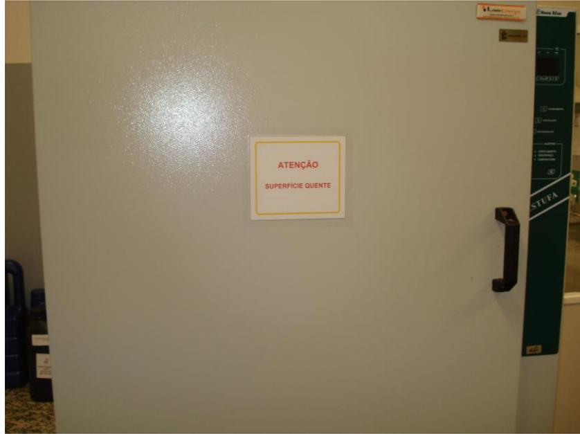
**FIGURA 3.25 - Indicação de Superfície Quente (Fonte: o autor), 2012**
