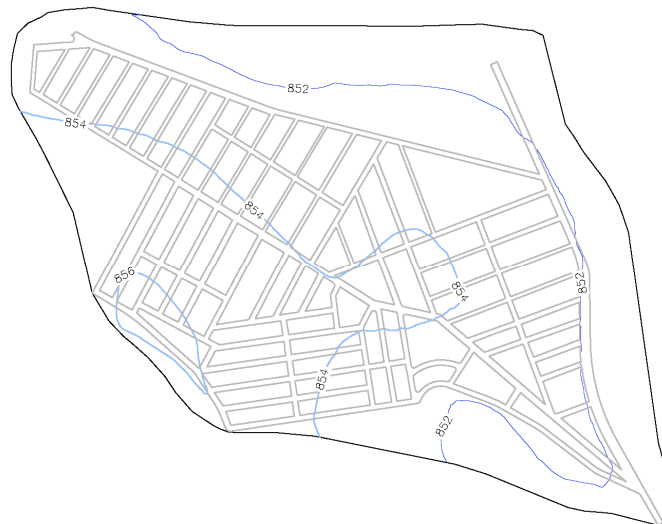
Figura 8 Terreno plano – curvas de nível em intervalos de 2 metros
