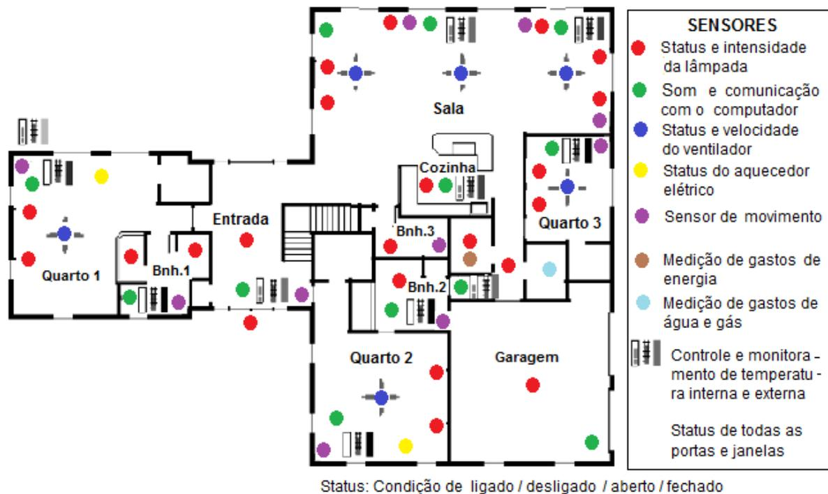
**Figura 10 – Planta baixa da Adaptive House com a localização dos sensores.**
