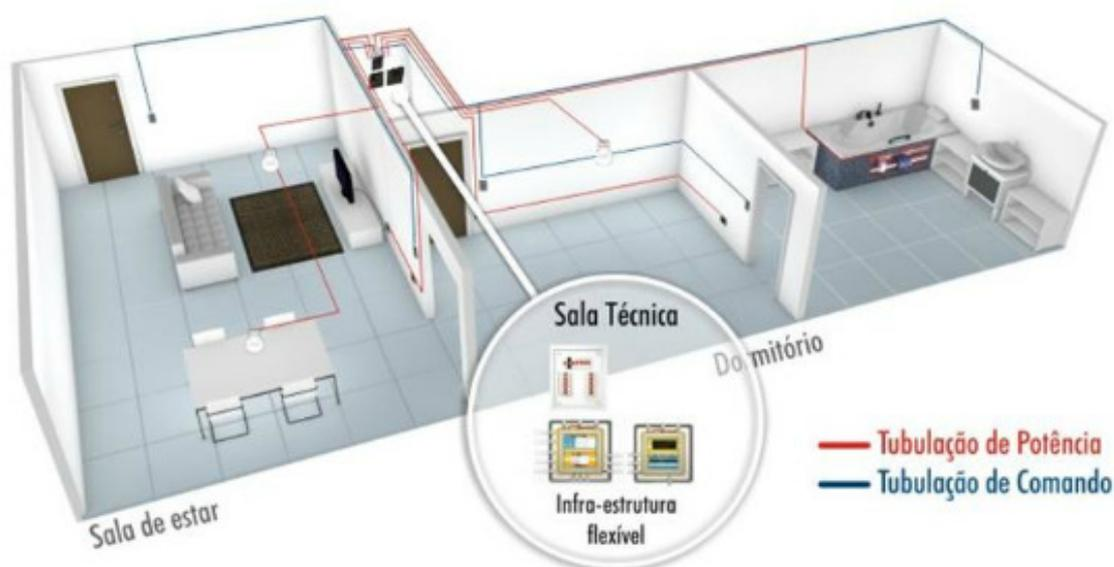
**Figura 9 – Ilustração de uma instalação centralizada através de sistema de cabeamento.**
