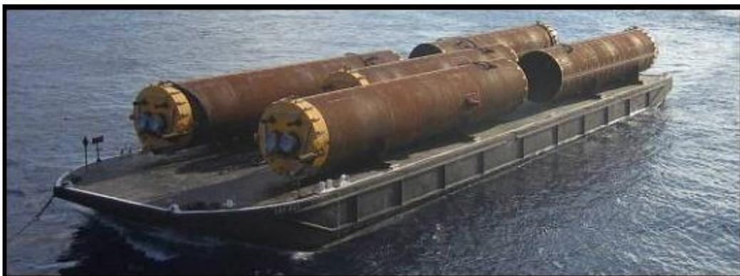
**Figura 2-17 – Transporte das Estacas de Sucção da Plataforma Spar-Buoy “Perdido”**
