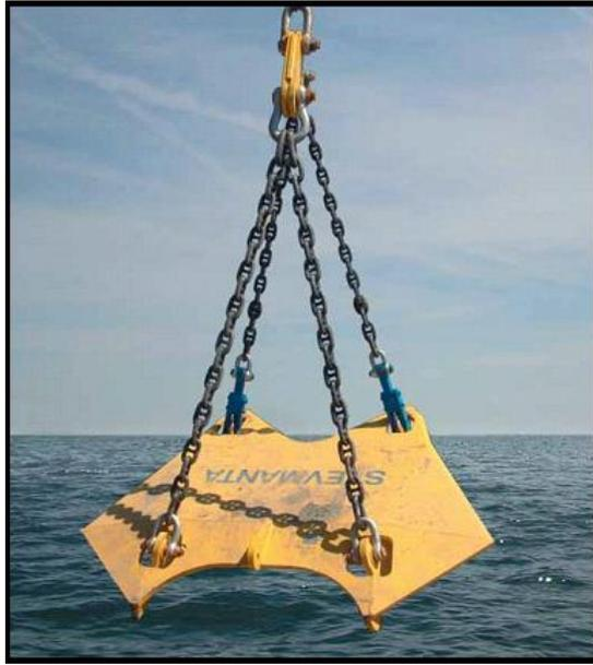
Figura 2-19 – Vista de uma Vertical Load Anchor (VLA)
