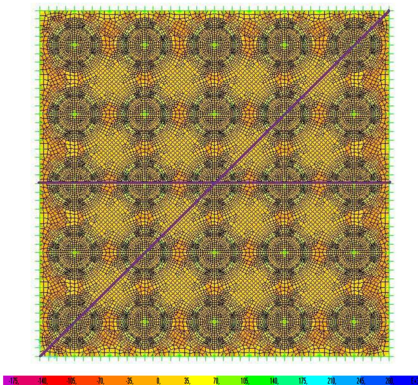
**Figura 21** – Tensões em x da malha quadrada com capitel circular [kN/m<sup>2</sup>]
