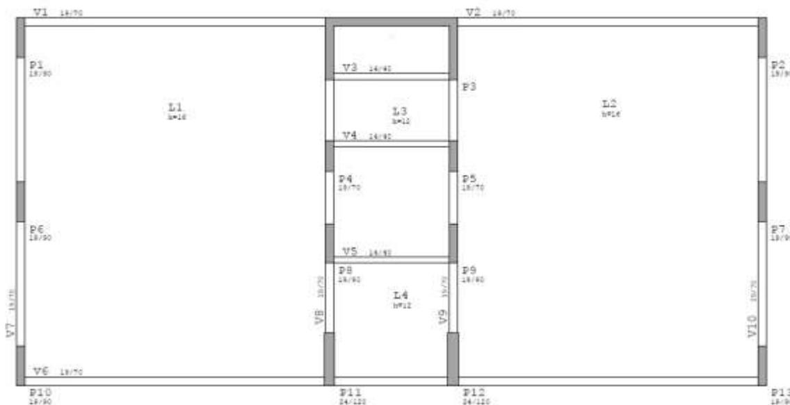
Figura 7 - Modelo estrutural do pavimento tipo no CAD/TQS
