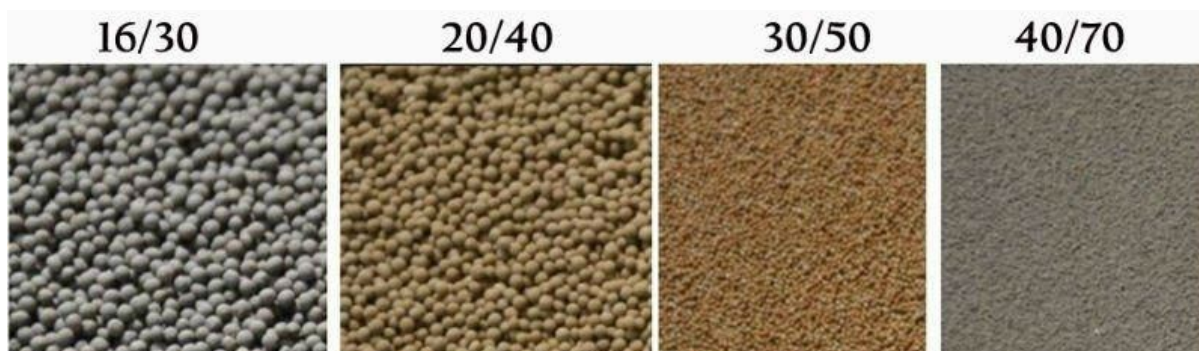
Figura 3.11. Diferentes Granulometrias para Propantes. Fonte: Adaptado de ALIBABA.COM, 2013.
