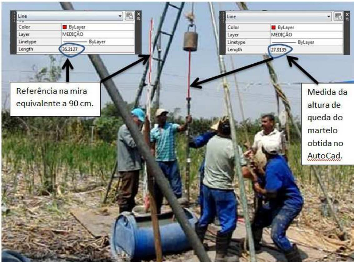
Figura 4.7 - Utilização do AutoCAD na obtenção e análise de dados de um quadro retirado com o auxílio do software Windows Live Movie Maker.
