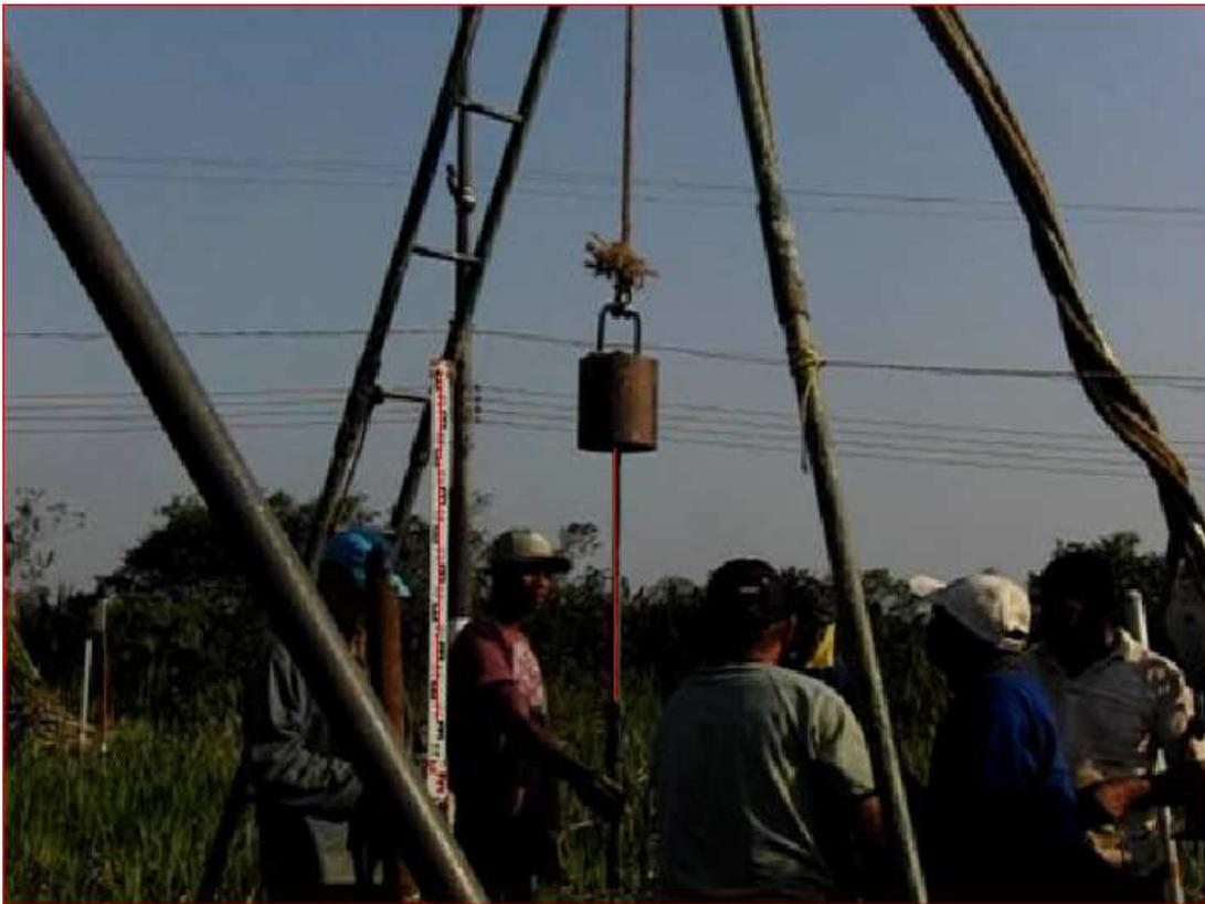
Figura 4.3 - Medição da altura de queda do martelo utilizando o software AutoCad.
