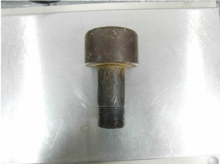
Figura 4.2 – Cabeça de bater utilizada no ensaio, SANTANA (2015).
