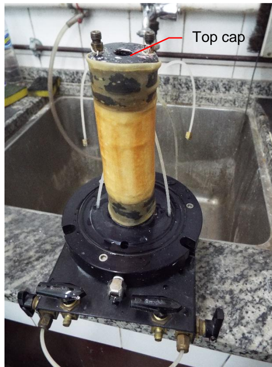
Figura 33 – Corpo de prova com top cap e membrana de látex
