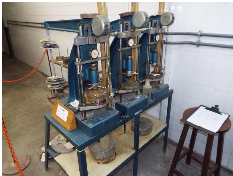
Figura 11 - Prensas do ensaio de adensamento oedométrico
