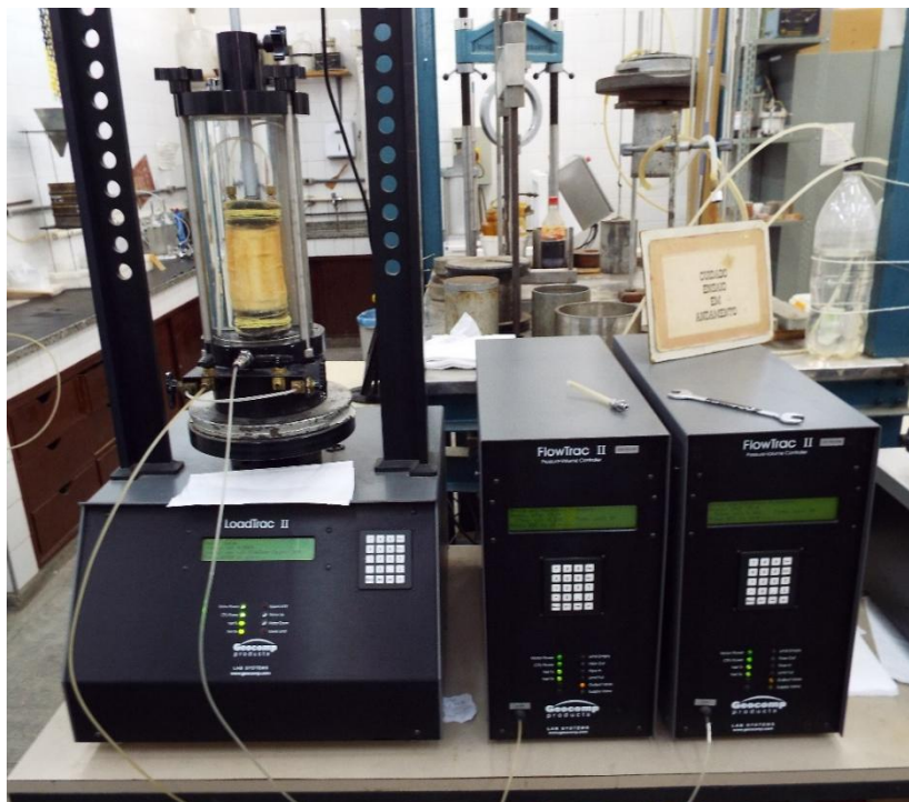
Figura 14 - Corpo de prova posicionado na prensa do ensaio de compressão triaxial
