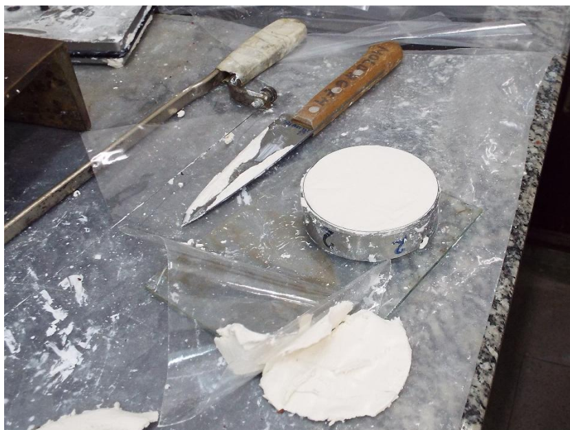
Figura 25 - Corpo de prova de adensamento oedométrico ao final da moldagem
