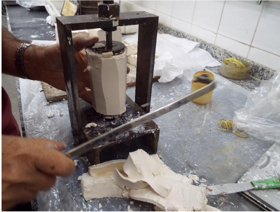
Figura 27 - Moldagem de corpos de prova de adensamento isotrópico e triaxial
