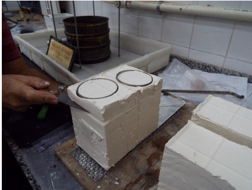
Figura 24 – Moldagem do corpo de prova para o adensamento oedométrico
