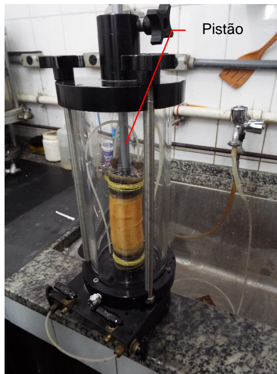
Figura 34 – Corpo de prova confinado na câmara de acrílico
