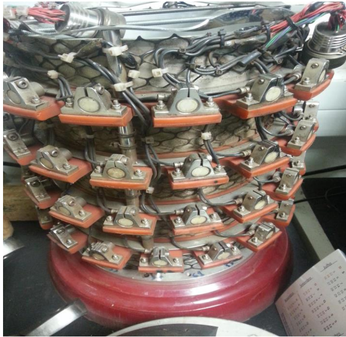
Figura 2.5 - Módulo com sensores de um PIG Ultrassom, para mapeamento de espessura do perfil metálico de dutos
