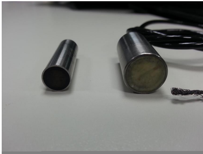
Figura 2.4 - Transdutores de imersão de 5MHz e de 15MHz, respectivamente, da esquerda para a direita. São utilizados para inspeção de corrosão de dutos com Scanner e PIG's
