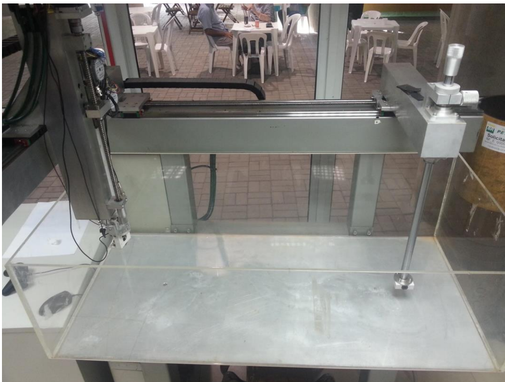
Figura 4.1 - Aquário para realização de testes com a eletrônica de ultrassom no CPTL.
