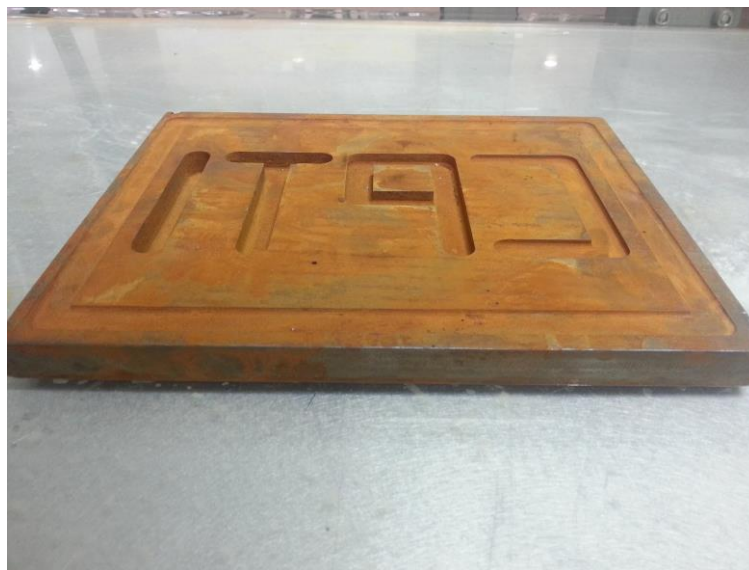
Figura 4.6 - Chapa metálica com diferentes espessuras para testes de medição no CPTI.
