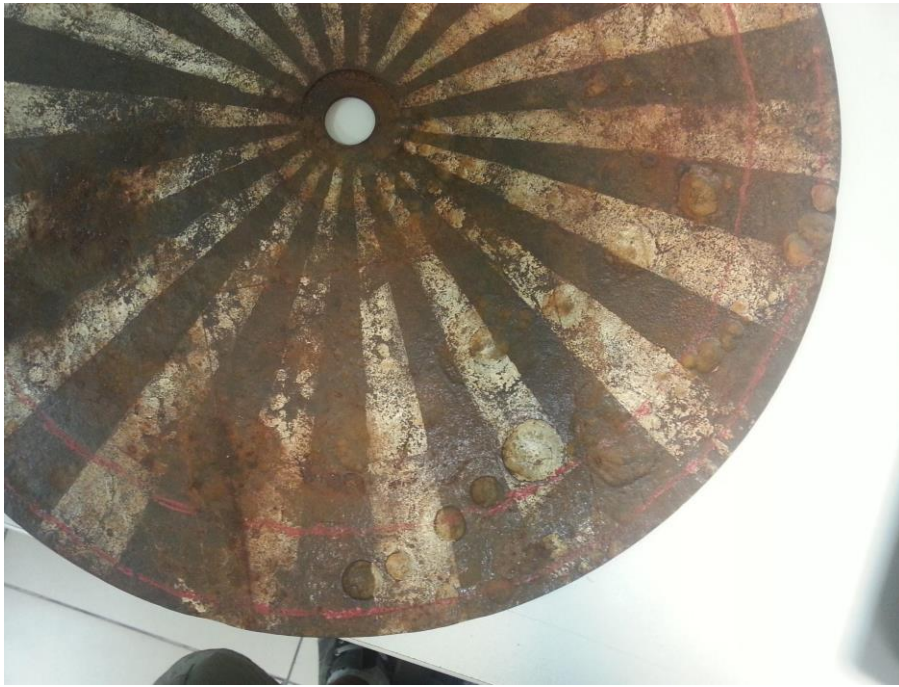
Figura 4.9 - Rotor com furos visíveis para testes com ultrassom.
