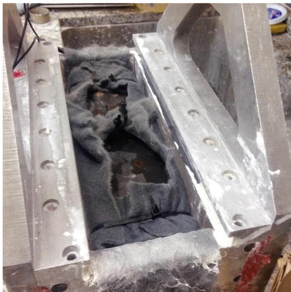
**Figura 50: Colocação das placas envoltas por geotêxtil.**
