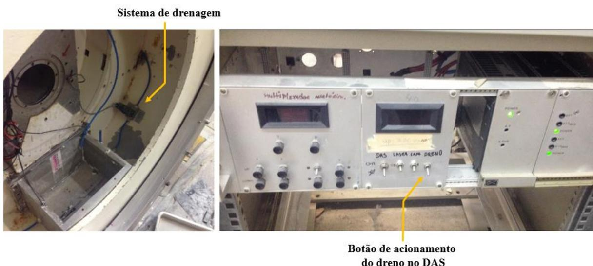
**Figura 77: Sistema de drenagem na centrífuga e o sistema de controle com o botão de acionamento.**
