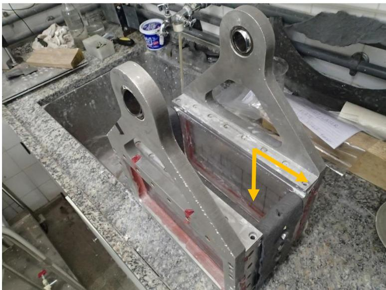
**Figura 47: Caixa com geotêxtil instalado e as direções de drenagem.**
