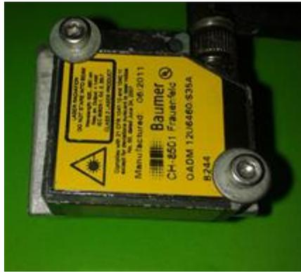
Figura 28: Sensor de deslocamento a laser (TREJO, P.C. N., 2015).
