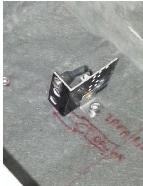
**Figura 73: PPT localizado a 5,5cm inserido na camada de caulim.**
