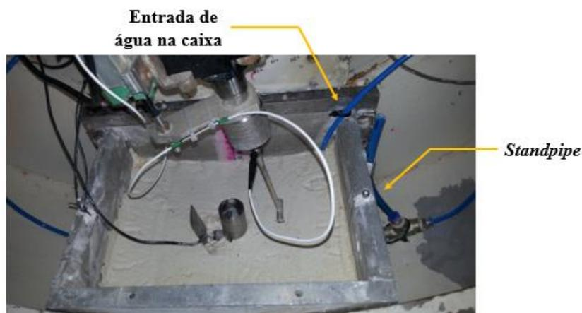
Figura 81: Sistema de abastecimento d'água e *standpipe* dentro da centrífuga.
