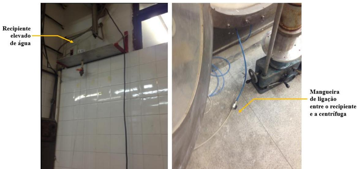
Figura 80: Sistema de abastecimento de água.
