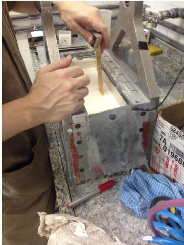
**Figura 49: Solo arrasado e verificação da altura desejada.**
