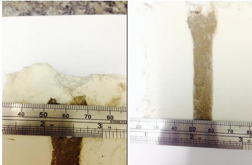
**Figura 67: Detalhe das dimensões da coluna no topo e na base após carregamento.**
