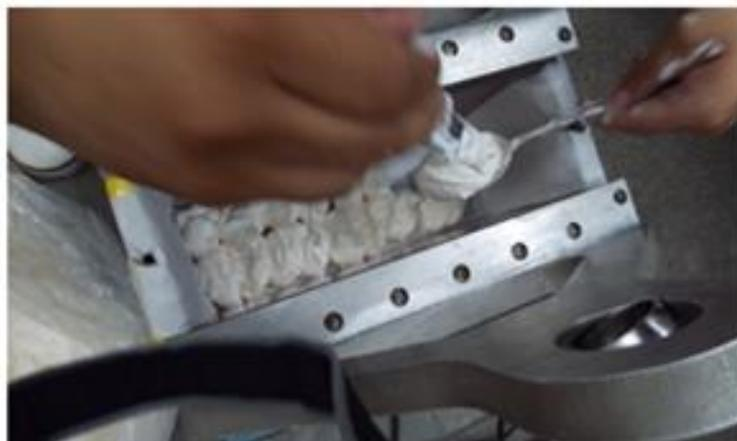
**Figura 48: Enchimento da caixa pelo método dos grumos (TREJO, 2015).**
