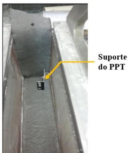
**Figura 46:** Caixa com o geotêxtil instalado e com o suporte do PPT.
