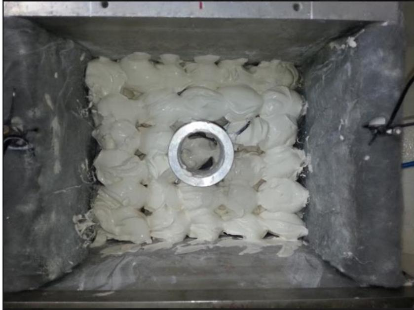
**Figura 75: Caixa e célula unitária sendo preenchidas pela técnica de grumos.**
