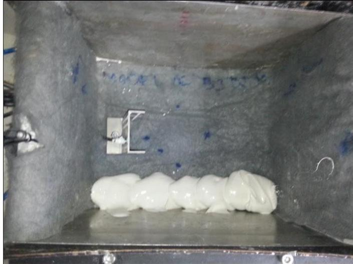
**Figura 72: Caixa sendo preenchida com caulim pela técnica de grumos.**
