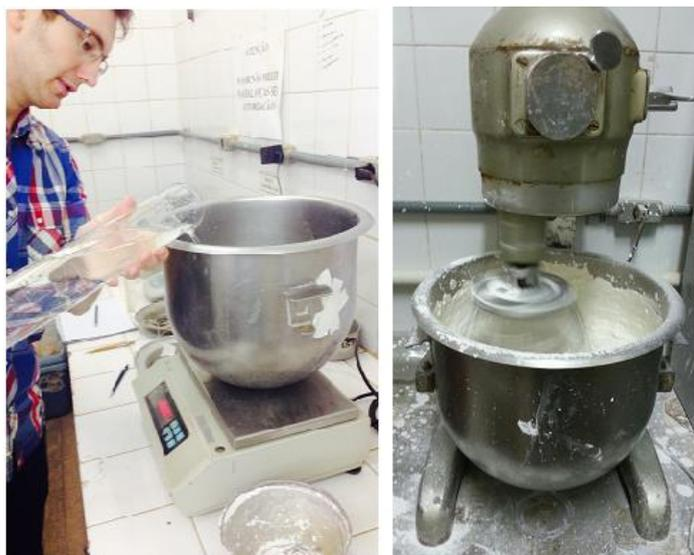
**Figura 45:** Água sendo vertida no recipiente para pesagem e a massa sendo misturada no *mixer*.
