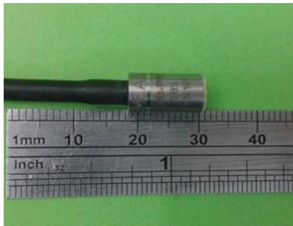
**Figura 25: Transdutor de poropressão (TREJO, 2015).**
