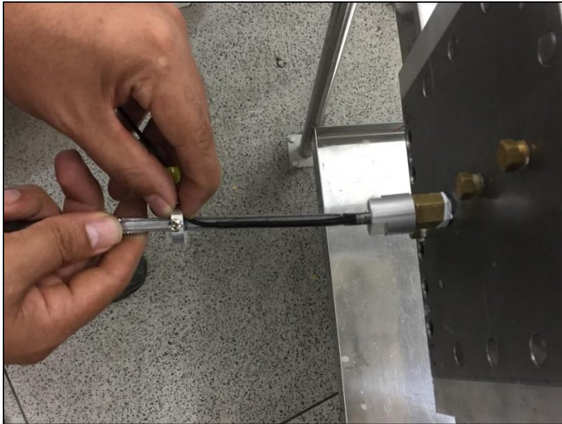
Figura 41 – Instalação do transdutor de poropressão
