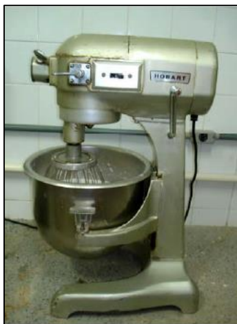
Figura 34 – Batedeira utilizado para mistura dos materiais (FERRAZ, 2006)
