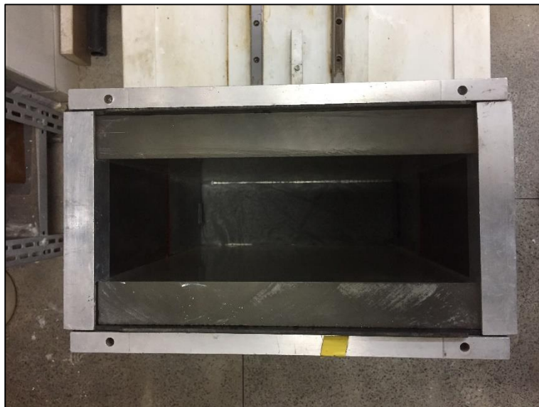
Figura 37 – Vista superior da caixa antes do preenchimento com a mistura
