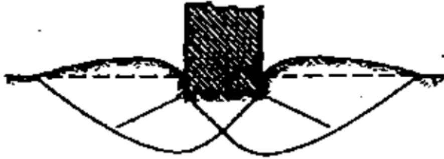
Figura 5.13 - Deformação do solo no modo de ruptura generalizada em fundações superficiais (VESIC, 1975)
