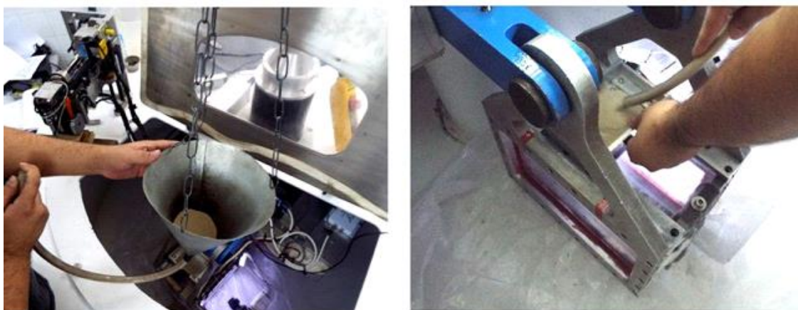
Figura 3.16 - Areia no funil (esq.) e início da pluviação (dir.)
