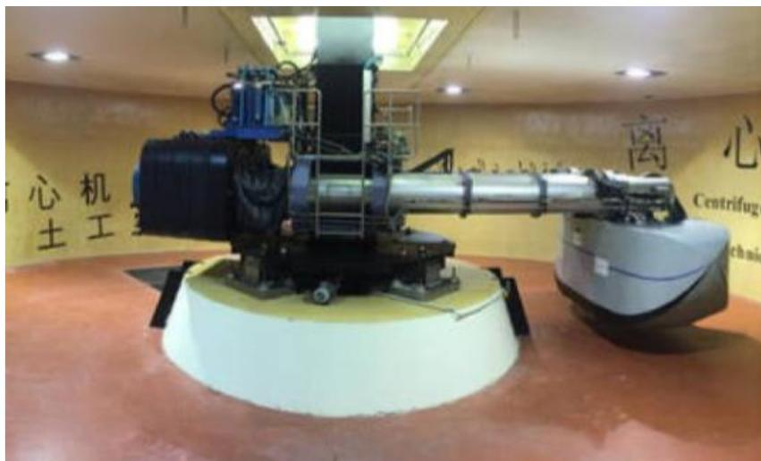
Figura 29 – Centrífuga geotécnica de braço do IFSTTAR (DERKX *et al.*, 2006, *apud* FERNANDES, 2018).
