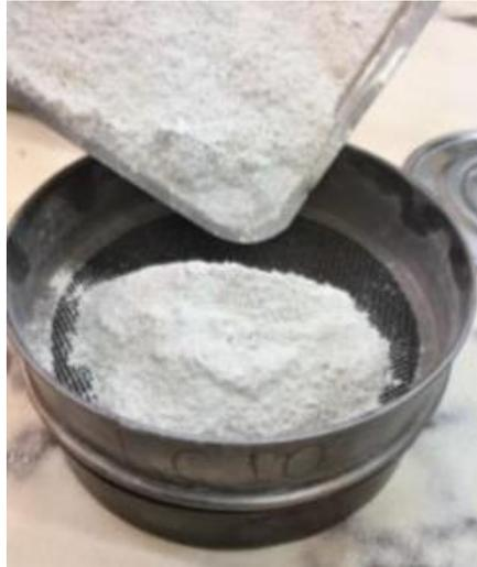
Figura 14 – Amostra seca do caulim *Speswhite*<sup>TM</sup> (ANDRADE, 2018).
