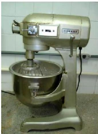
Figura 19 – Batedeira utilizada para mistura do solo com água (ANDRADE, 2018, *apud* FERRAZ, 2006).
