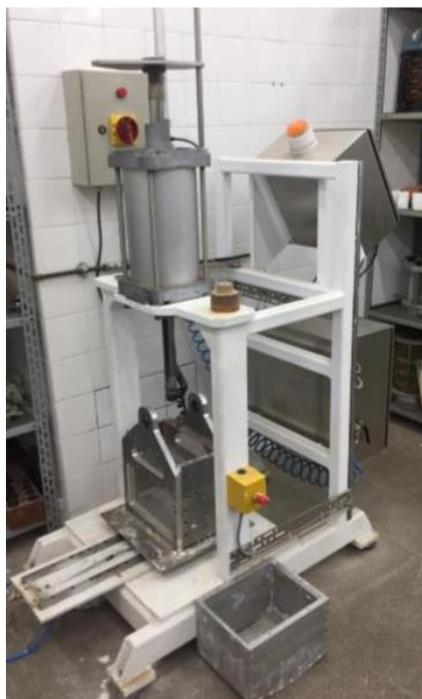
Figura 20 – Adensômetro do Laboratório de Geotecnia da COPPE/UFRJ (ANDRADE, 2018).
