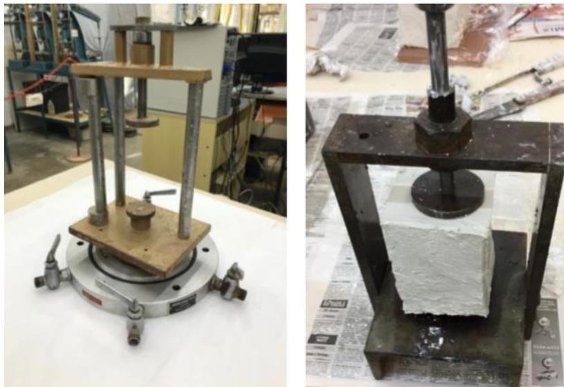
Figura 23 – Equipamento utilizado para moldagem dos CP após adensamento no adensômetro.
