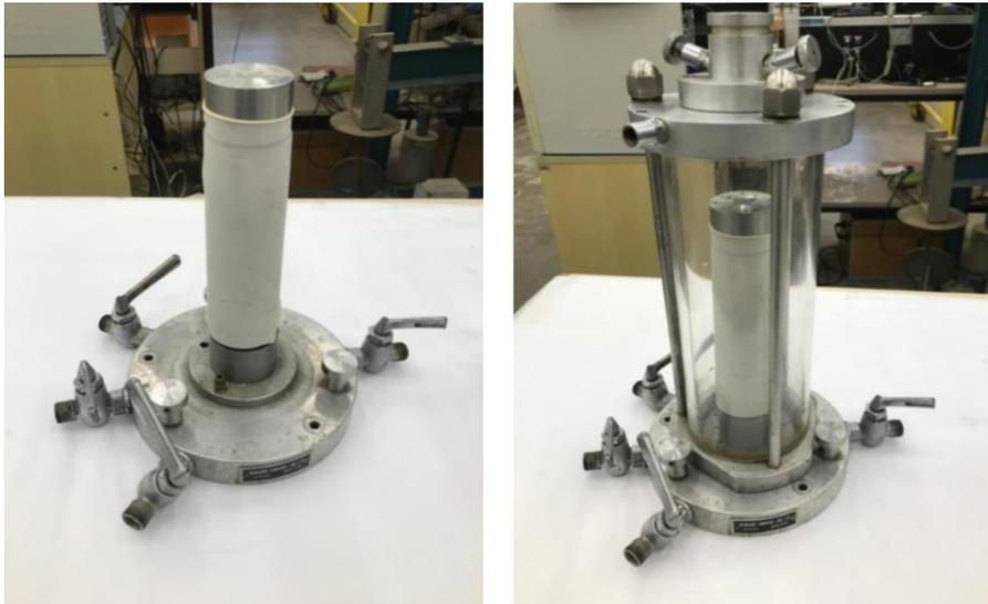
Figura 26 – Representação da câmara a ser utilizada para os ensaios triaxiais.
