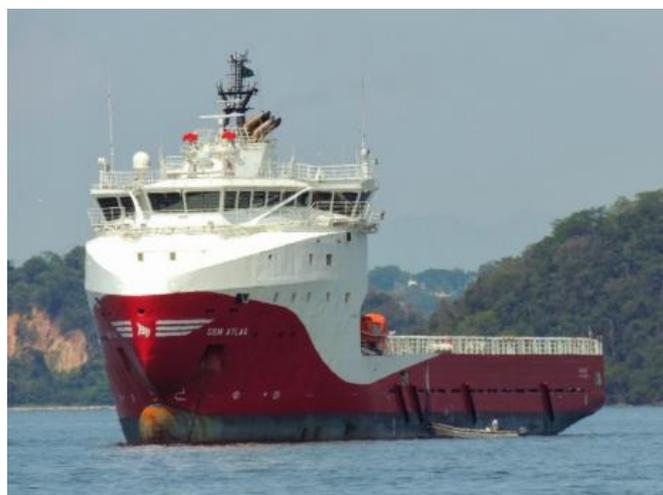
Figura 10: Embarcação conhecida como *Platform Supply Vessel* (PSV)
