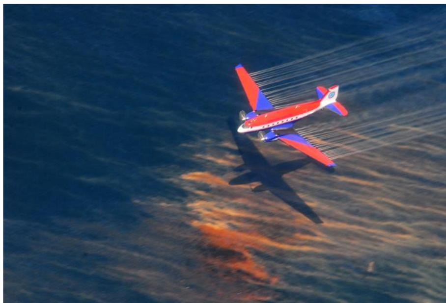
Figura 25: Aeronave aplicando dispersantes na superfície da mancha de óleo causada pelo incidente na *Deepwater Horizon*
