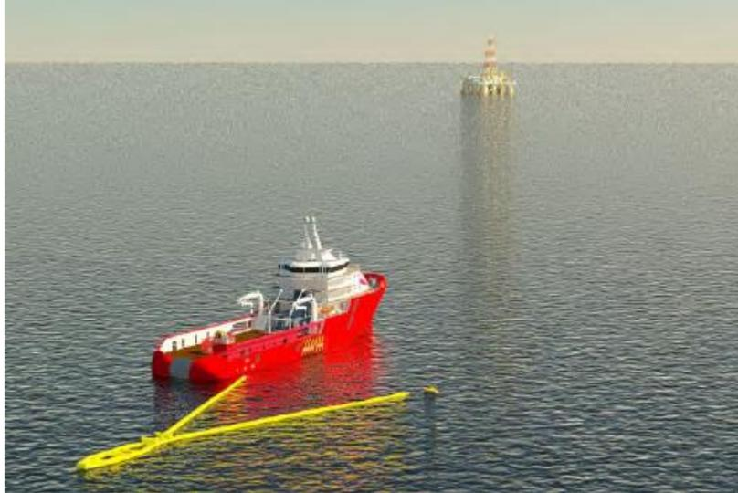
Figura 7: Barreira de Alta Velocidade (Modelo NOFI *Current Buster 6*)
