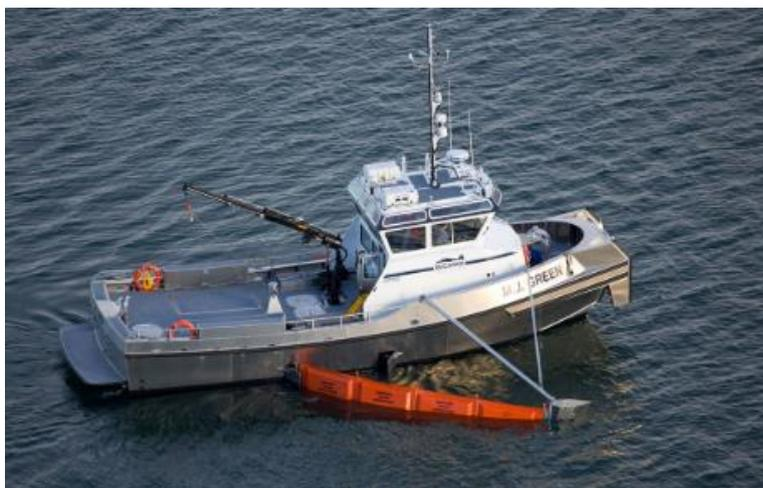
Figura 9: Embarcação conhecida como *Oil Spill Response Vessels* (OSRV)
