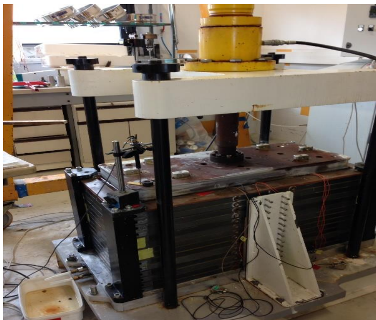
Figura 3.3 - Caixa de ensaio do tipo ESB Figura retirada de Tarazona (2016)
