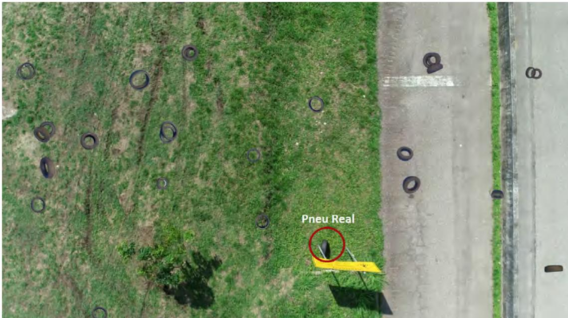
Figura 5.7: Exemplo de *quadro* do vídeo 0019 contendo pneus inseridos com o método de casamento de luminâncias e um pneu real
