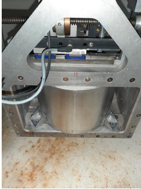
Figura 33: Fixação da caixa cilíndrica no suporte.
