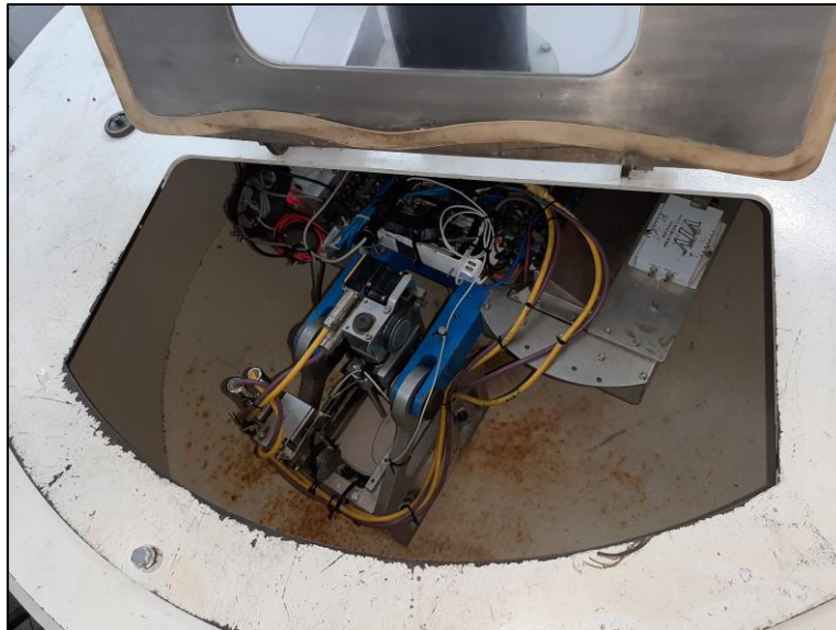
Figura 24: Centrífuga de braço do LM2C: (a) Vista frontal com a centrífuga fechada; (b) Vista lateral com a centrífuga aberta; e (c) Vista superior da centrífuga aberta, com sua estrutura interna à mostra.
