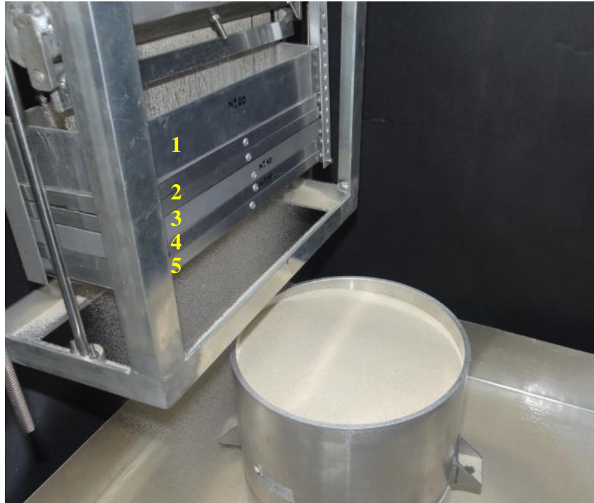
Figura 19: Disposição do conjunto de peneiras na calibração da pluviação da areia QZ, conforme disposto na Tabela 4.
