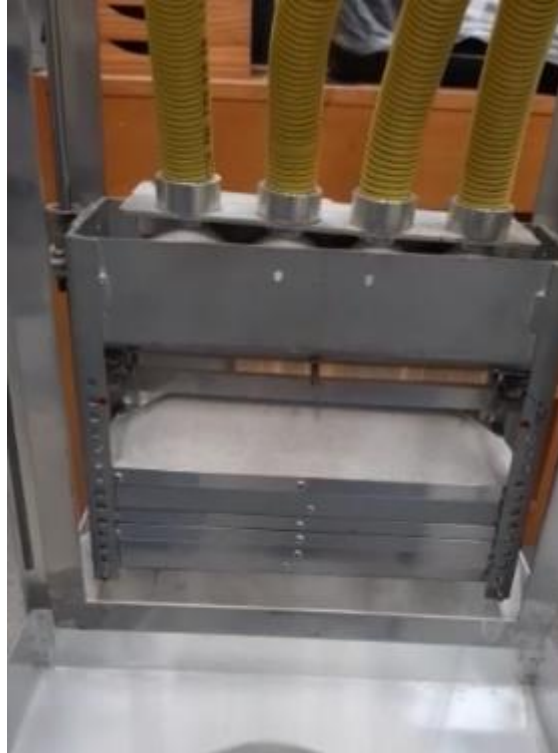
Figura 20: Retenção de partículas observada no ensaio executado na areia CA80 com a configuração da areia QZ.
