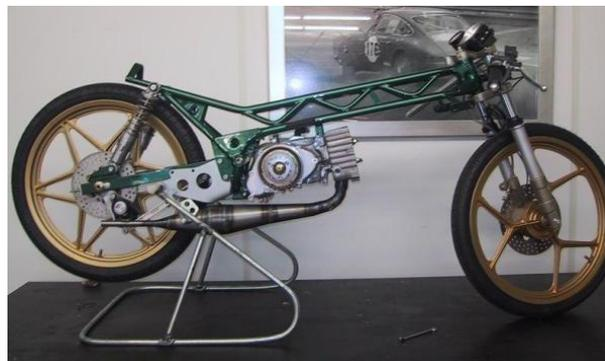
Figura 5: Motocicleta com quadro do tipo *backbone*. Fonte: [11]
