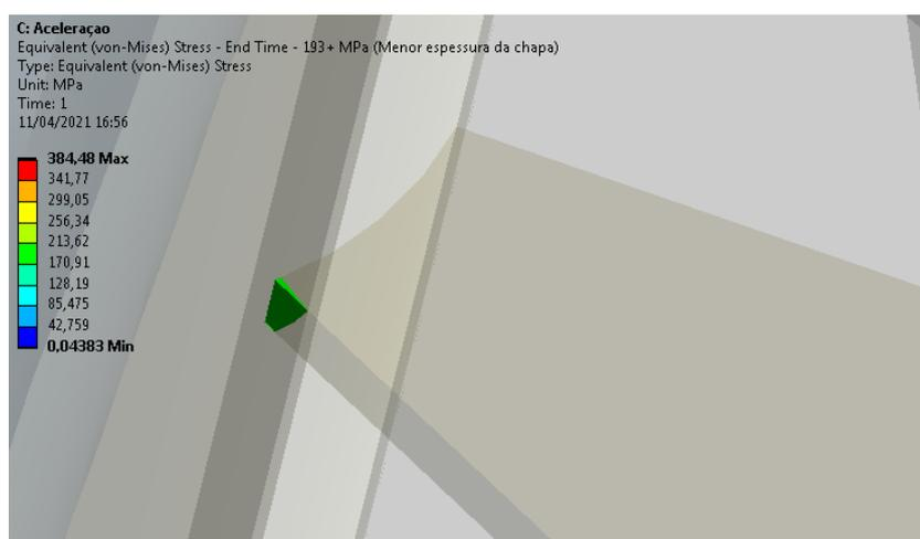
Figura 55: Aceleração, Região 5 – Chapa de reforço do suporte da suspensão traseira - Tensão global acima de 193 MPa.
