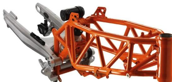
Figura 7: Quadro de perímetro treliçado KTM. Fonte: [13]
