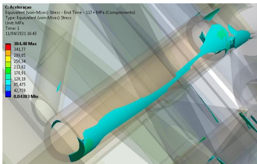
Figura 45: Aceleração, Região 1 - Tubo frontal inferior - Tensão global acima de 117 MPa.
