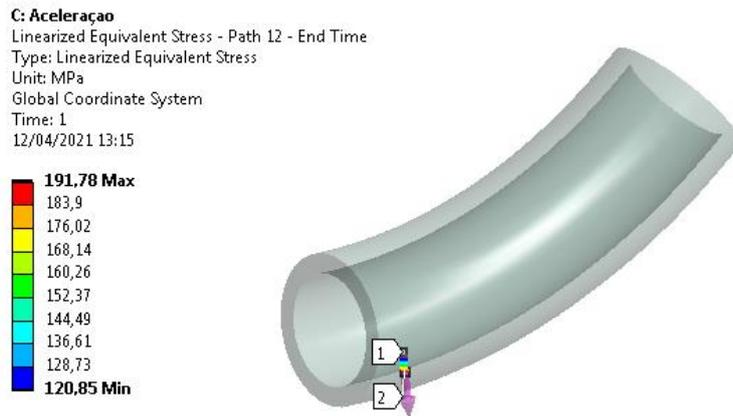
Figura 71: Aceleração, Path 12 - Tensão linearizada na menor espessura do tubo.
