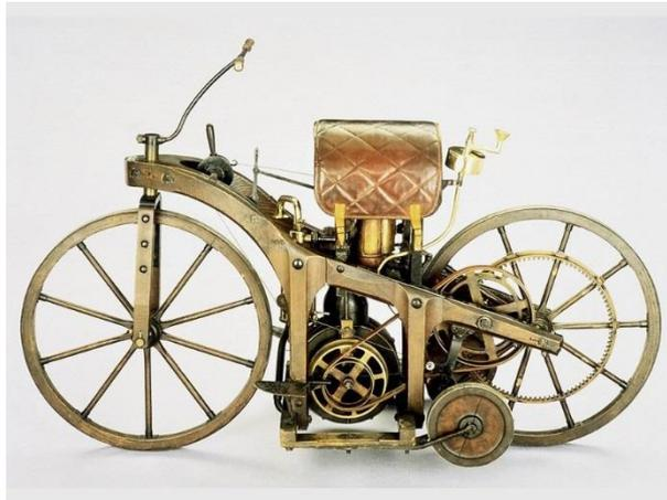
Figura 1: Petroleum Reitwagen, a primeira motocicleta com motor à combustão interna. Fonte: [3].
