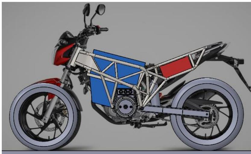
Figura 27: Comparação entre a versão final do quadro, com componentes instalados, e o modelo de fábrica em escala real.
