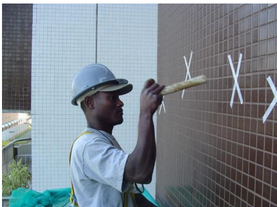
Figura 4.44: Ensaio a percussão em revestimento com pastilhas. O “x” indica locais com som cavo (OLIVEIRA D. F., 2013).
