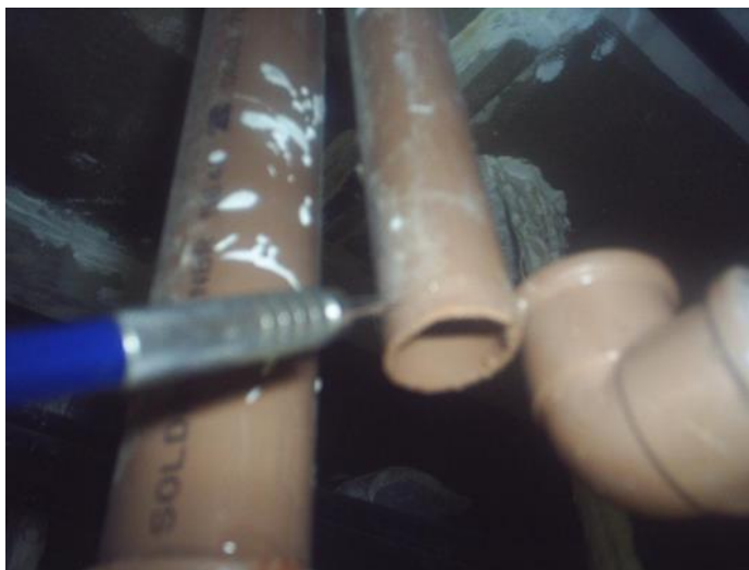
Figura 3.5: Tubo desconectado pela pressurização do sistema (OLIVEIRA D. F., 2013).
