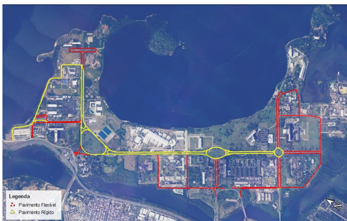
Figura 15 - Vias a serem pavimentadas da Ilha do Fundão. As vias em amarelo são destinadas ao pavimento rígido e as vias em vermelho destinam-se ao pavimento asfáltico.
