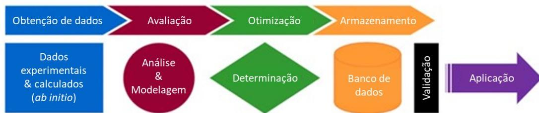
Figura 2.18: Etapas da metodologia CALPHAD para desenvolver bancos de dados. O Thermo-Calc segue rigorosamente essas etapas ao desenvolver seus bancos de dados para termodinâmica e cinética. Adaptado de [82]
