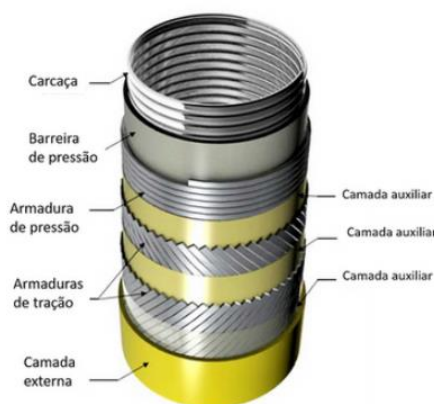
Figura 6 – Representação das camadas de um duto flexível
