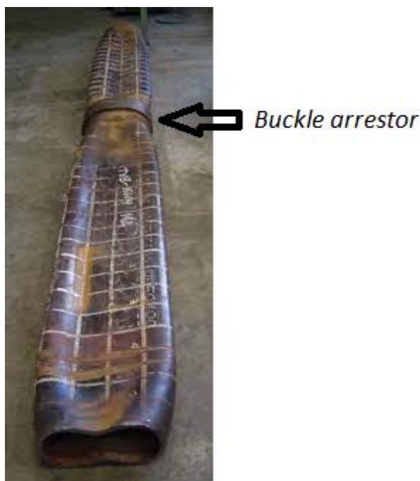
Figura 17 – Trecho de tubo em colapso
