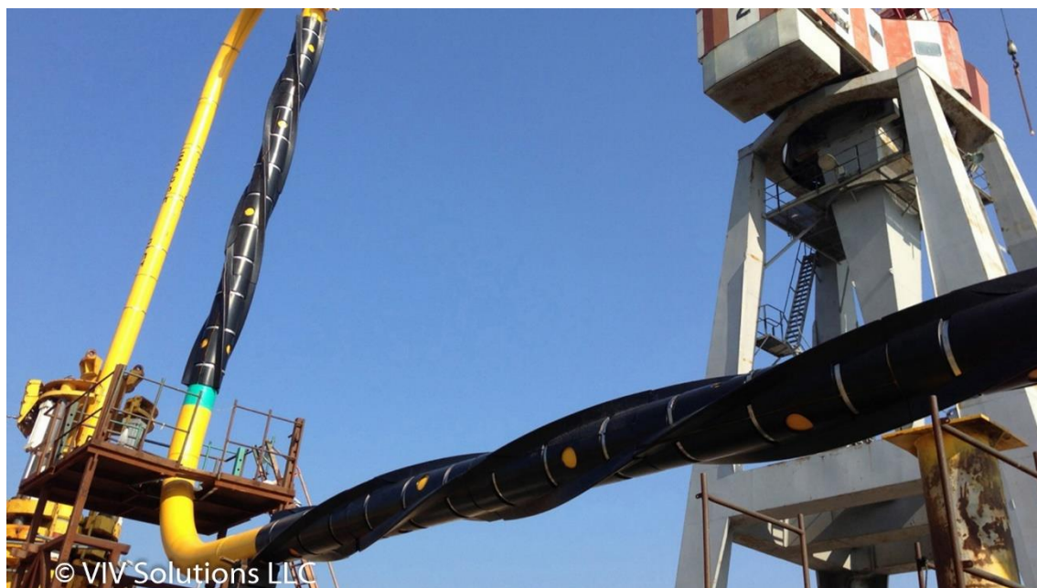
Foto de strakes instalados em um jumper
