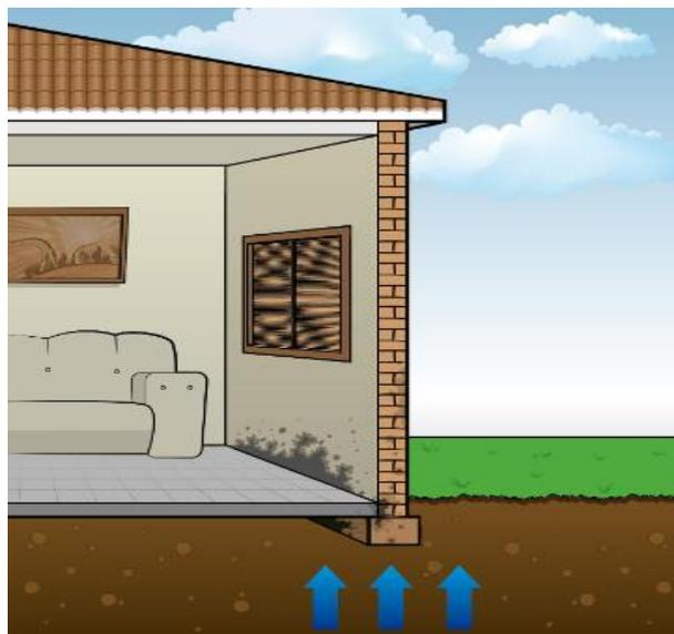
Figura 2.6 Fluxo da capilaridade do solo subindo a construção (PRODUTOIMPERMEABILIZANTE, 2012).
