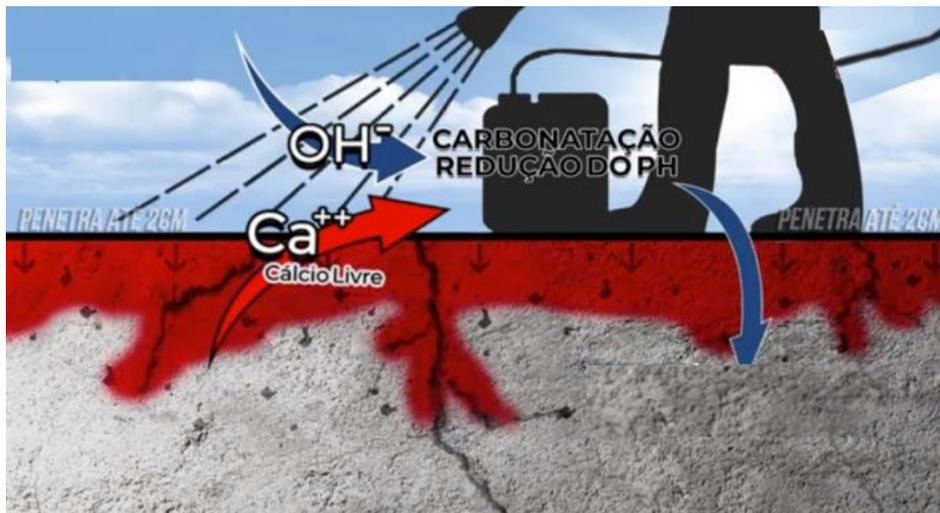
Figura 5.11 Processo químico do produto com o cálcio livre do concreto na aplicação do produto (ALCHEMCO, 2023).
