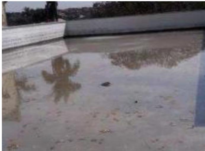
Figura 6.5 Teste de estanqueidade do sistema por 72 horas (AUTOR).
