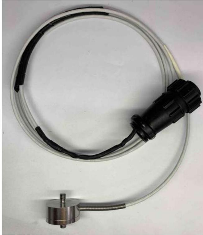
Figura 3.15: Célula de carga LC202-50.
