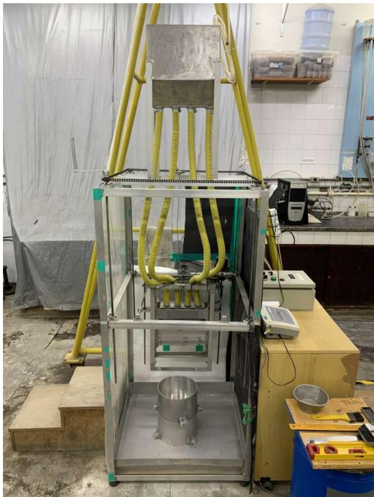
Figura 3.2: Pluviador automático.
