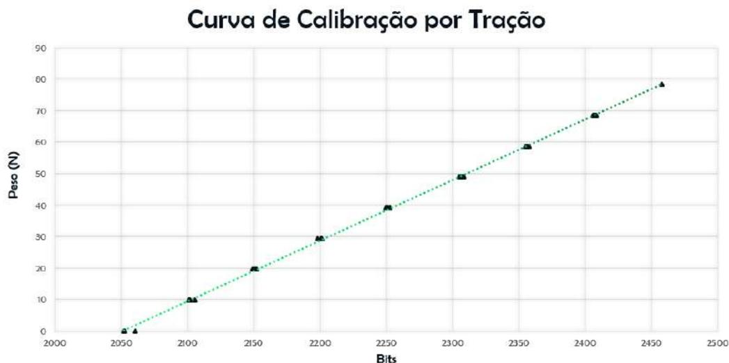
Figura 3.29: Curva de calibração de tração.
