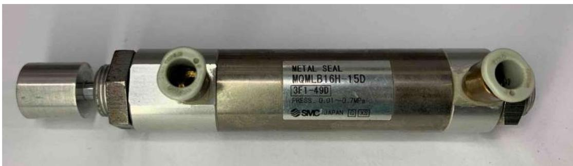
Figura 3.10: Cilindro Pneumático MQMLBL6H-15D.
