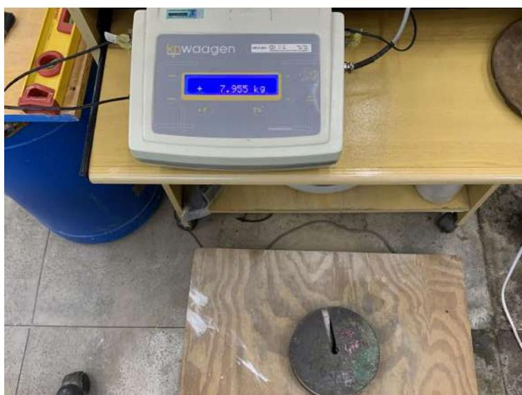
Figura 3.23: Massas utilizadas no processo de calibração.
