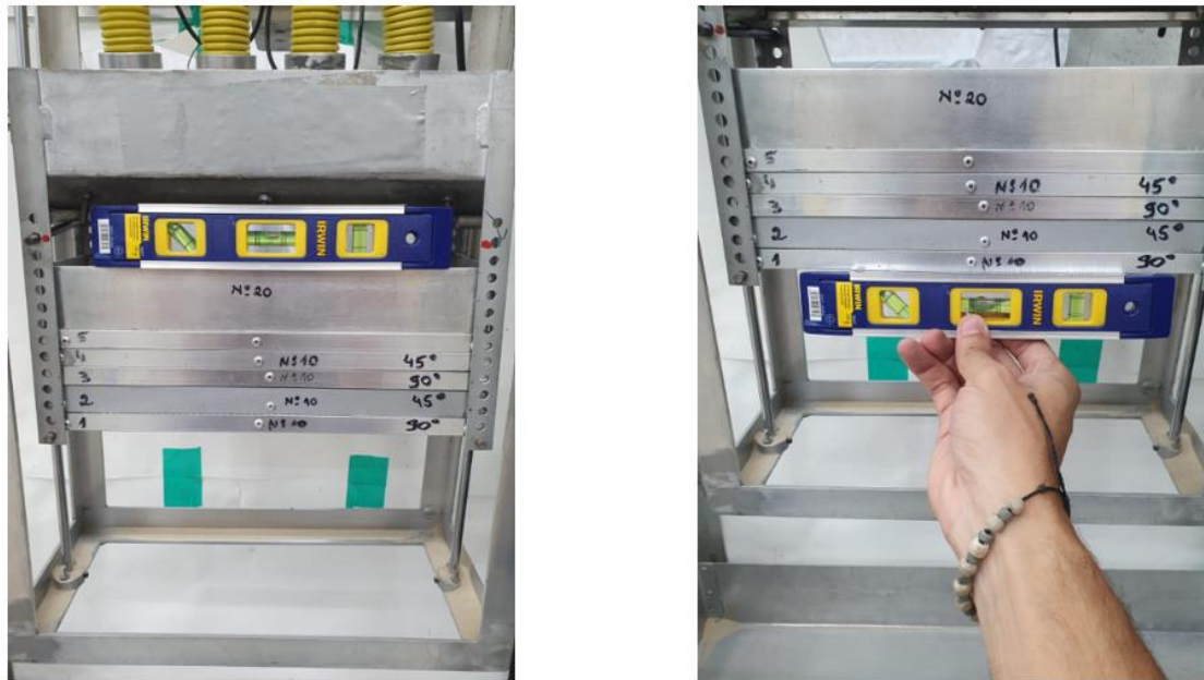
Figura 3-16 - Nivelamento das peneiras do pluviador automático
