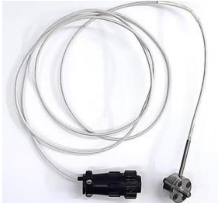
Figura 3-9 - Célula de carga de 5000 N utilizada nos ensaios de CPT
