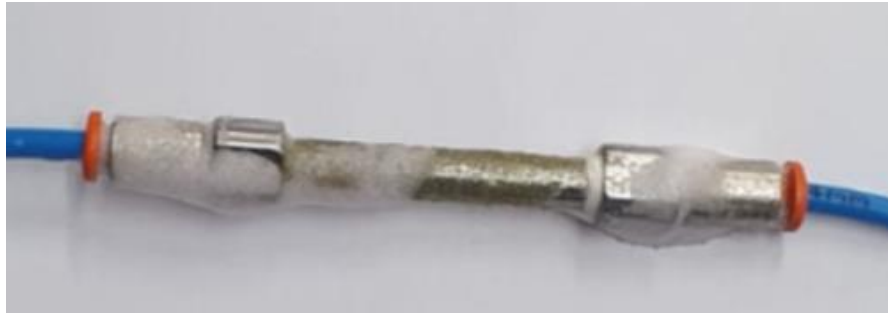
Figura 3-7 - Teste de vedação do air hammer
