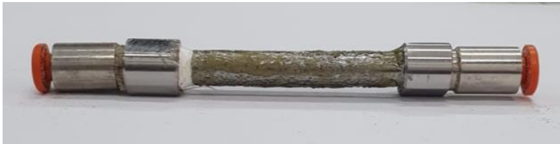
Figura 3-5 - Areia colada com epóxi na parte central do cilindro do air hammer
