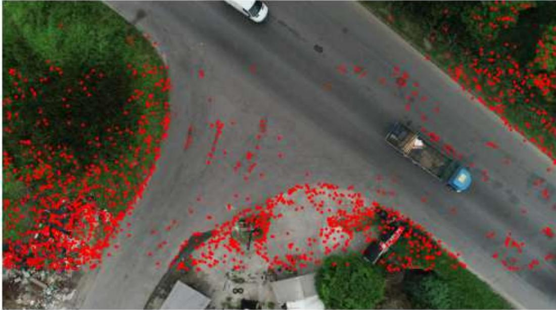
Figura 2.2: Imagem com pontos vermelhos representando *features* detectados em uma imagem.
