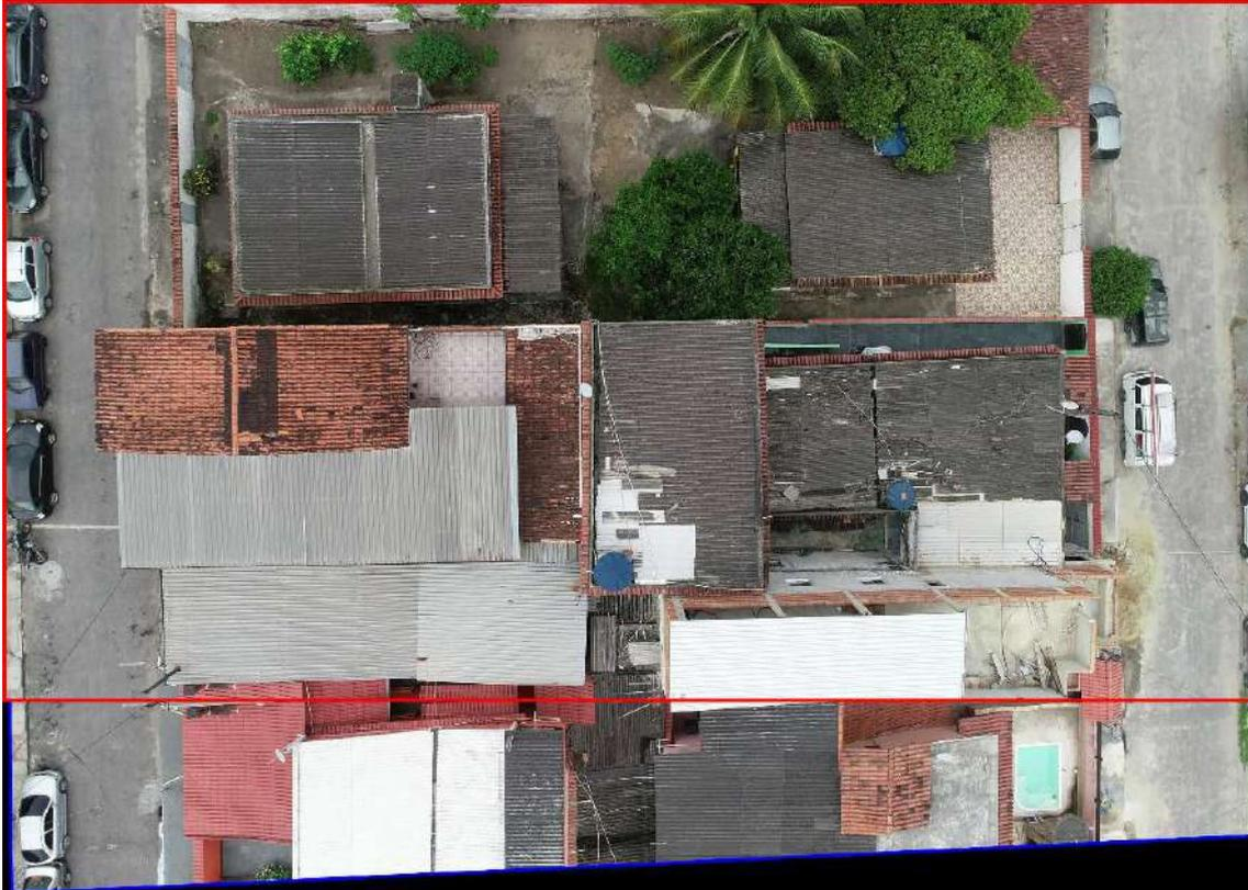
Figura 2.3: Costa de duas imagens utilizando a matriz de homografia.
