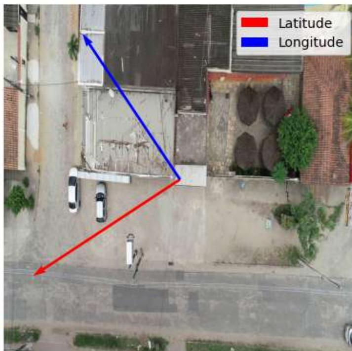
Figura 3.21: Direção dos versores de latitude e longitude em um quadro.
