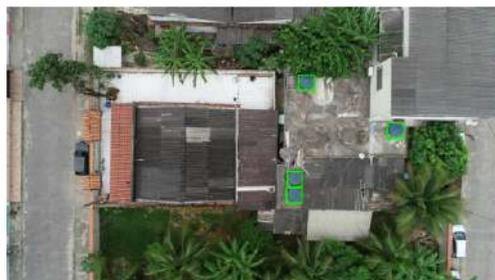
(b) Caixas delimitadoras apresentadas em quadro não retificado após uso da homografia entre o quadro retificado e não retificado.
