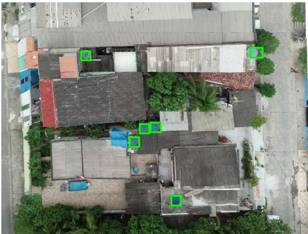
Figura 3.20: Imagem ampliada de um trecho da costura apresentando as *bouding boxes* de caixas d'água anotadas na base de dados.
